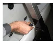
Desserrez la molette qui se situe sur le tube du châssis.
